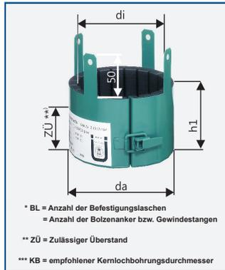
Die Brandschutzmanschette "UNIFOX" besteht aus einem Stahlblechmantel der mit dem aufschäumenden Baustoff "fox-o-flex" ausgekleidet ist. Das Blähmaterial expandiert bei Hitzeeinwirkung ab ca. 180° C um mehr als das 18-fache des ursprünglichen Volumens und quetscht das erweichende Rohr zusammen. Durch den Spannverschluss kann die Manschette schnell und problemlos geöffnet und geschlossen werden.
